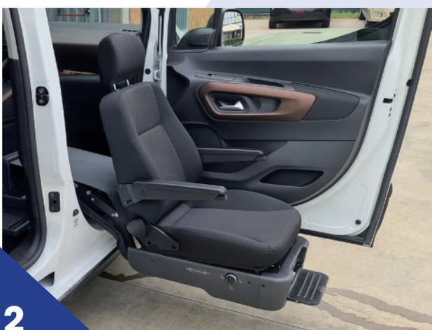
S-TRAN viene fornito completo di poggiatesta e finiture di pregio con carenature in ABS. In caso di anomalie, un apposito sistema di emergenza ne consente la funzionalità in modo "manuale".
