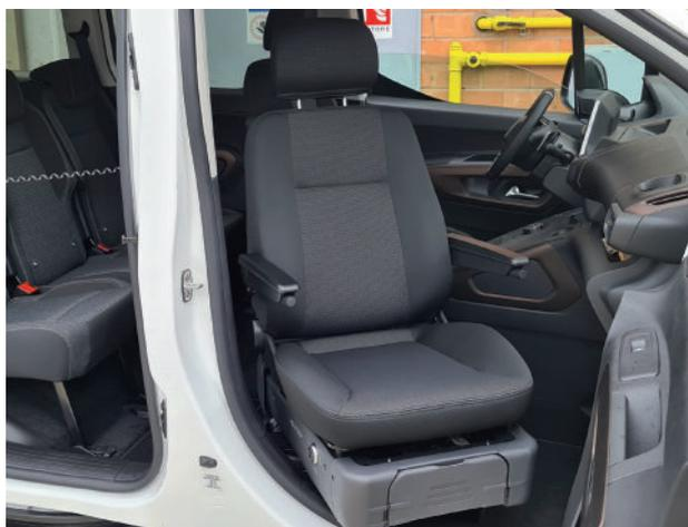
Il sistema consiste in un sedile ergonomico integrato ad una base che permette oltre alla rotazione verso l'esterno, anche la possibilità di abbassare lo stesso dal livello di marcia sino al livello ottimale di trasferimento esterno, e viceversa.
