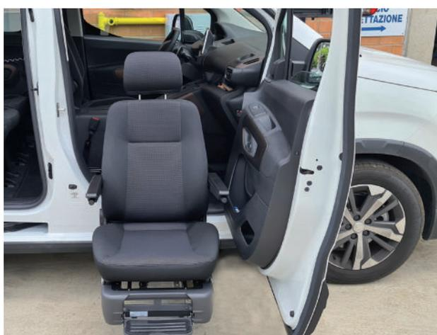
Il sistema è interamente automatico in tutte le sue funzioni, quindi rotazione, fuoriuscita; discesa e viceversa. Tutte le funzioni sono "programmabili" e quindi, una volta impostate, tutti i movimenti avvengono in sequenza automatica una volta avviato il programma. Inoltre, grazie alle funzioni programmabili, il sistema è adattabile ad ogni esigenza dell'utente.
